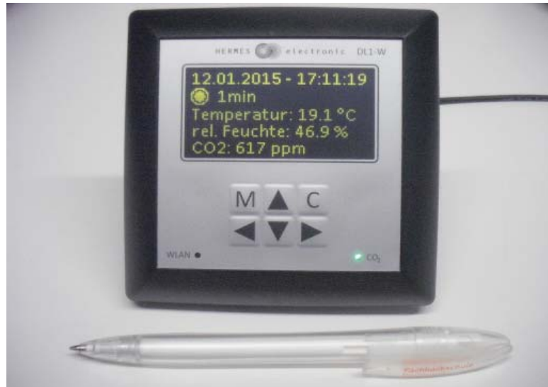
Abbildung 3: Zentrales Element zur Erfassung der Komfortsituation ist der Datenlogger für CO 2 , Feuchte und Lufttemperatur. Aufgrund der Kommunikation über WLAN wird am Anschlussort lediglich eine Steckdose benötigt.
